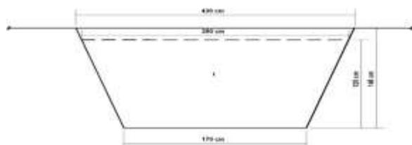
Gambar 8 Penampang aliran maksimum saluran primer 1
